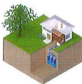
Pompe à chaleur sur corbelles géothermiques
