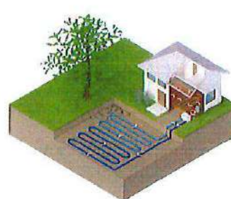
Pompe à chaleur sur capteurs enterrés horizontaux
